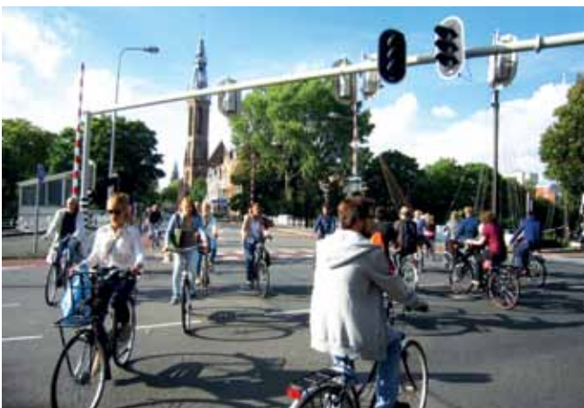
„Tegelijk Groen“ – Rundum-Grün: An einigen Knotenpunkten in Groningen hat der Radverkehr seine eigene Signalphase, bei der alle Radler an allen Knotenarmen, unter Berücksichtigung der Vorfahrtregel rechts vor links, fahren dürfen.
